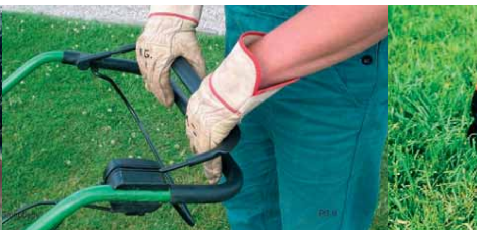
Bild 2: Totmannschaltung mit Motorbremse
